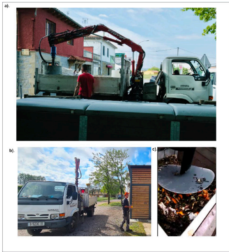
Figura 4.11. Herramientas utilizadas en los escenarios mecanizados del SDC. a) Camión con grúa en operación: mecanizada. con sistema de protección: el camión está equipado con un aro de soporte que permite fijar la mezcladora de manera segura cuando no está en uso o durante los desplazamientos, protegiendo la maquinaria de posibles daños. Brazo hidráulico con la mezcladora acoplada en la punta, lista para introducirse en el compostador y realizar la aireación de forma completamente (b) Camión con brazo hidráulico retraído: se muestra la parte frontal del vehículo junto a un operario del equipo municipal de mantenimiento, quien sostiene el mando a distancia con el que se controla toda la operación. (c) Mezcladora en funcionamiento: detalle del movimiento helicoidal de la herramienta dentro del compostador, generando aireación homogénea y facilitando el proceso de descomposición de la materia orgánica. Fuente: Elaboración propia
