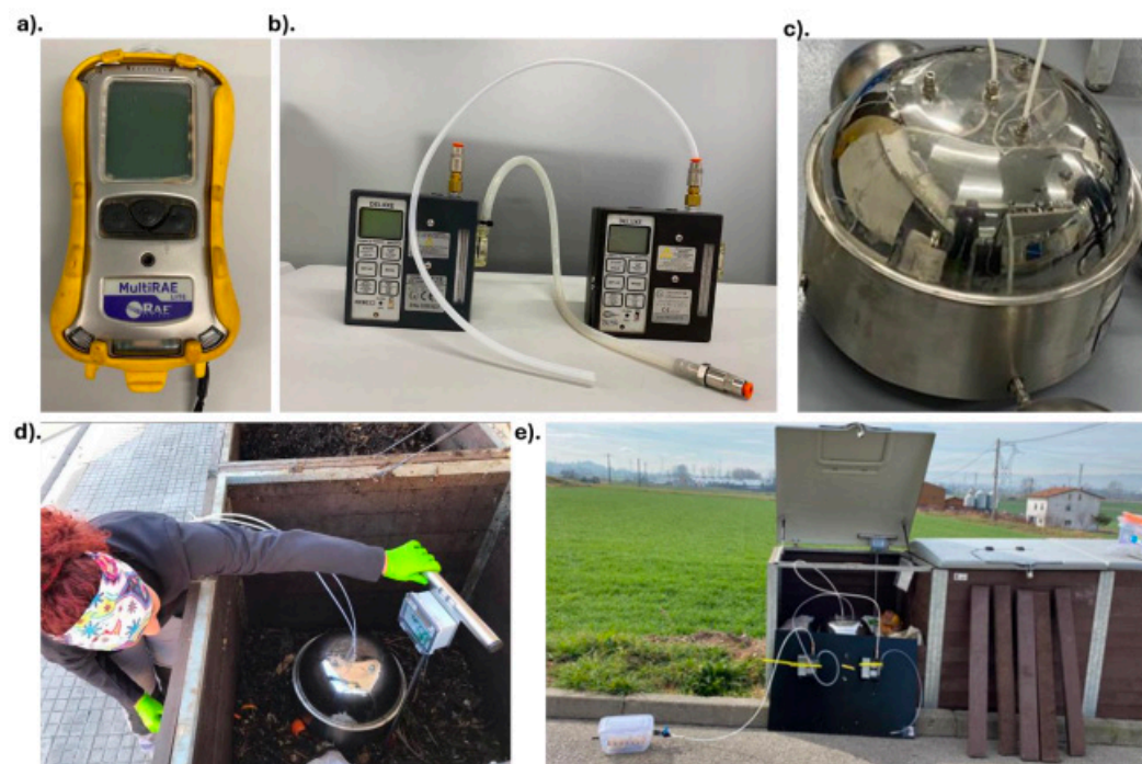
Figura 3.25. Equipos utilizados para muestreo de emisiones. Equipo multiRAE (a), Bombas para suministro de aire (b), Flux chamber (Scentroid) (c), sonda de temperatura para compostaje (d), Montaje de equipo para muestreo de gases (e). Fuente: Elaboración propia
