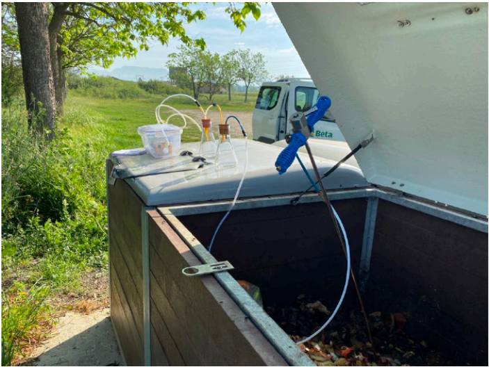
Figura 4.33. Método empleado para monitorizar el oxígeno en el sistema de compostaje. Fuente: elaboración propia
