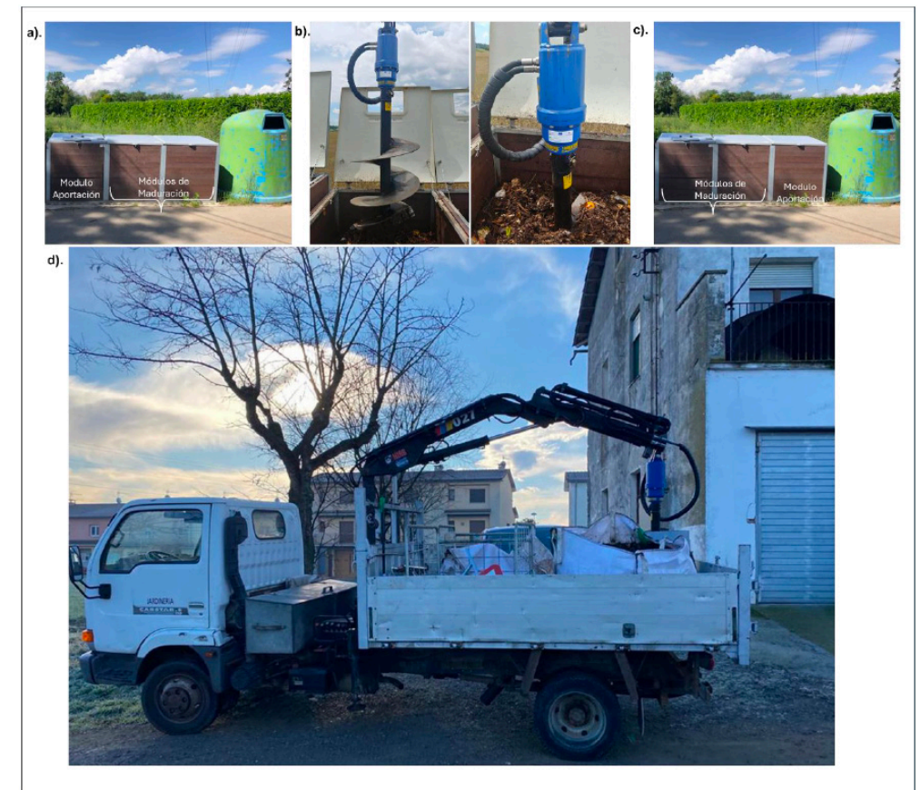
Figura 4.13. Esquema operativo del escenario 3A del SDC en LMR. a) Distribución del sistema: módulos diferenciados para la aportación y maduración de la fracción orgánica, que se alternan de forma cíclica según el avance del proceso. (b) Mezclador mecánico: equipo que se introduce en el módulo mediante grúa y cuyo movimiento helicoidal permite airear y homogeneizar el material sin necesidad de intervención física directa. (c) Transvases evitados: el sistema está diseñado para que el módulo de aportación pase automáticamente a fase de maduración sin mover la materia entre módulos, eliminando una de las tareas más exigentes físicamente. (d) Camión con grúa hidráulica: permite la instalación y retiro del mezclador, así como la carga y descarga de big bags con compost. Todo el sistema es operado mediante control remoto, reduciendo el esfuerzo humano y el tiempo de trabajo. Fuente: Elaboración propia
