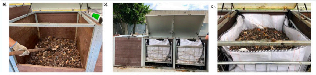
Figura 4.7. Implementación de rollcontainers en escenarios 2A y 2B para evitar el transvase manual entre módulos. (a) Movimiento de la materia orgánica hasta el rollcontainer segundo módulo de maduración; (b) ubicación de los rollcontainers dentro de los dos módulos de maduración, lo que permite mantener el compost contenido y facilitar su manipulación sin trasvase; (c) aspecto del material compostado en el último módulo de maduración, con coloración oscura, textura homogénea y fragmentos parcialmente estabilizados, indicativos de un proceso avanzado de compostaje. Fuente: Elaboración propia
