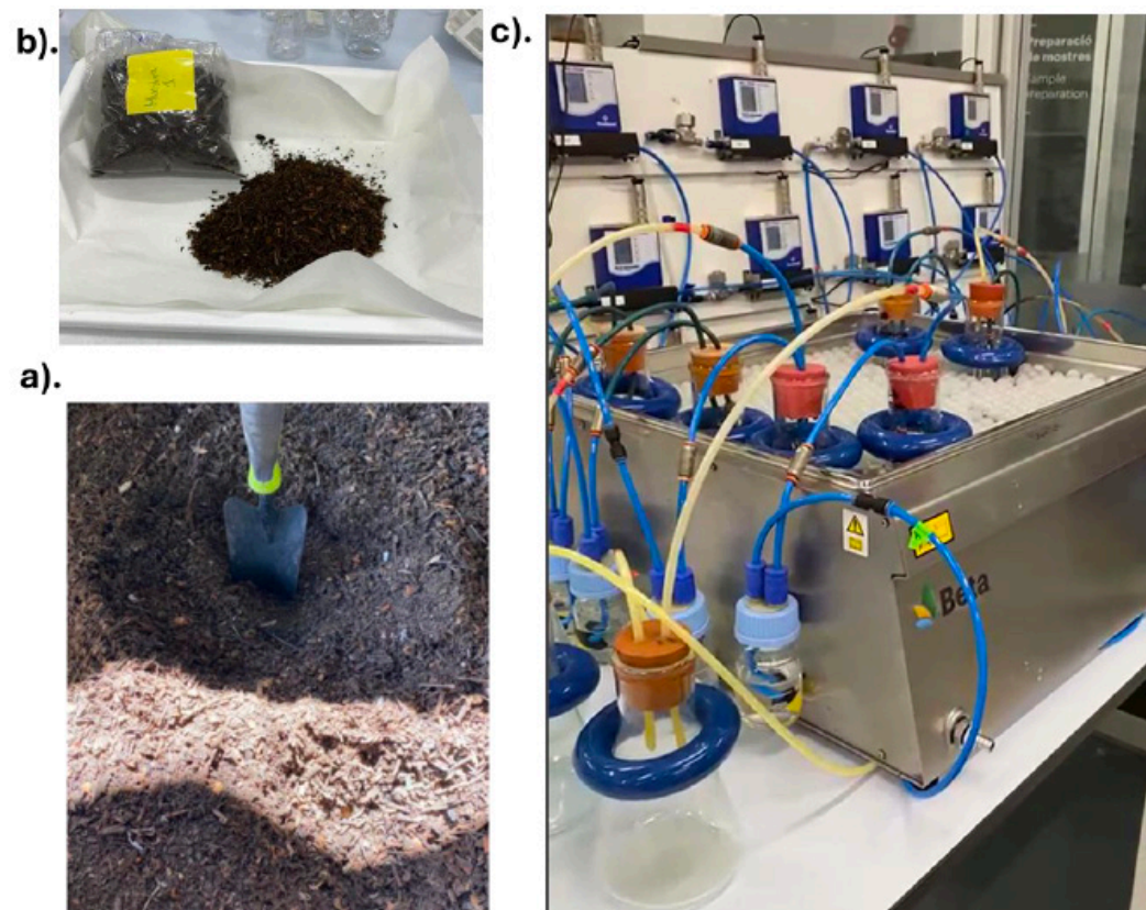
Figura 3.24. Respirometrías dinámicas del compost obtenido (a) Compost obtenido posterior a su tamizado, (b) muestra analizada en la laboratorio, (c) Equipo Respirómetro. Fuente: Elaboración propia
